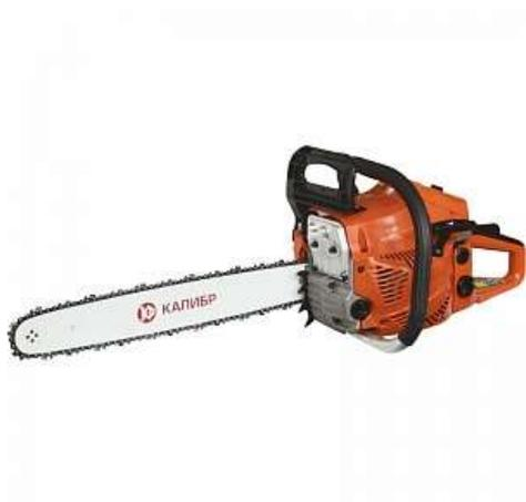
Пила бензиномоторная цепная Калибр БП-2200/18У предназначена для валки и раскряжёвки (распиливание на брёвна) деревьев, заготовки дров и выполнения других строительных работ.
