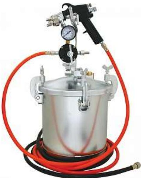
Краскораспылительный бак Калибр КБ-10 представляет собой герметически закрытый сосуд переносного типа, который предназначен для подачи лакокрасочных составов к краскораспылителю под действием сжатого воздуха, поступающего от компрессора, баллона или от пневмосети. Используется в строительно - отделочных работах при окраске поверхностей большой площади.
