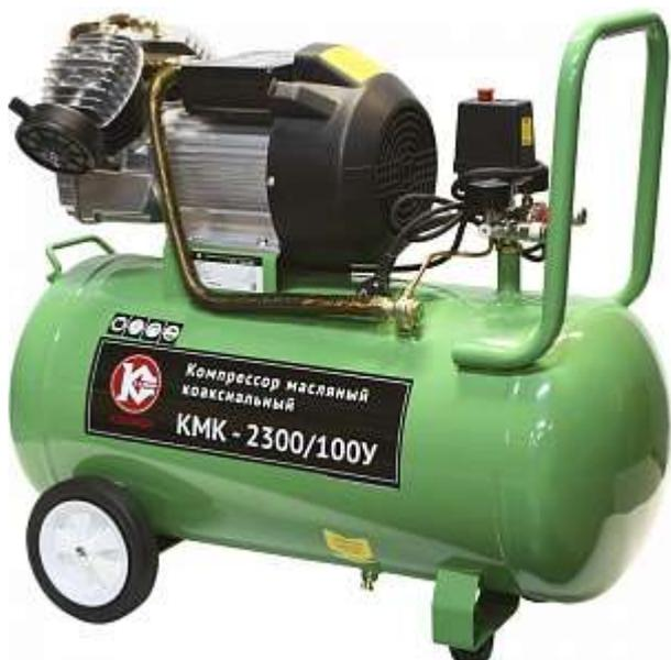
Компрессор масляный коаксиальный Калибр КМК-2300/100У предназначен для получения сжатого воздуха. Использование компрессора позволяет значительно сэкономить электроэнергию, механизировать труд и повысить качество работ, за счёт подключаемого пневмоинструмента.
