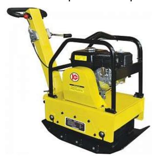
Бензиновая виброплита Калибр БВП-30/4200Р предназначена для проведения дорожностроительных работ при уплотнении различных сыпучих строительных материалов, грунтов, асфальта, асфальто-бетона.
