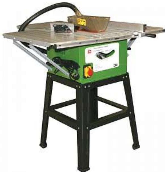
Электрическая пила настольная Калибр ЭПН-1700+СТ предназначена для продольного или поперечного, косо́го, наклонного и комбинированного пиления заготовок древесины, облицованной древеси́ны, древесностружечных плит, столярных плит и других аналогичных материалов.
