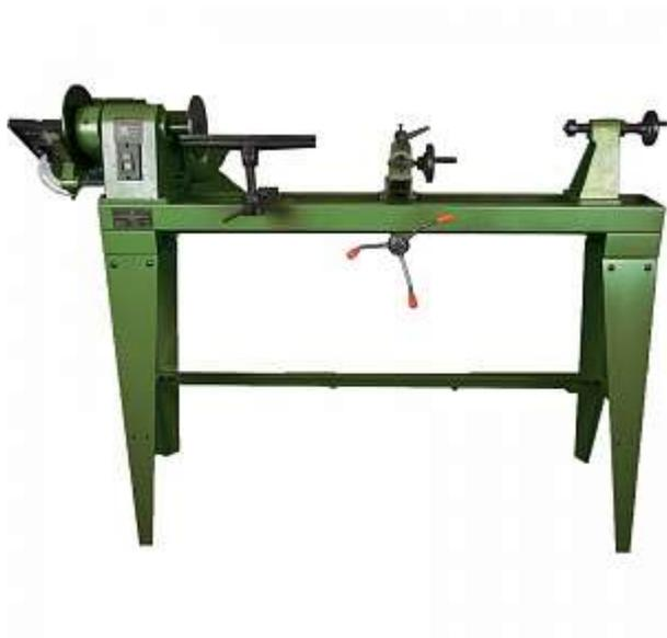
Станок токарный деревообрабатывающий Калибр СТД-700 предназначен для токарной обработки, шлифовки и полировки деревянных деталей и всех видов пластмасс.
