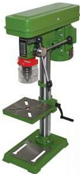
Сверлильный станок Калибр СС-16D/600 предназначен для выполнения сверлильных работ по дереву, пластмассе и металлу.
