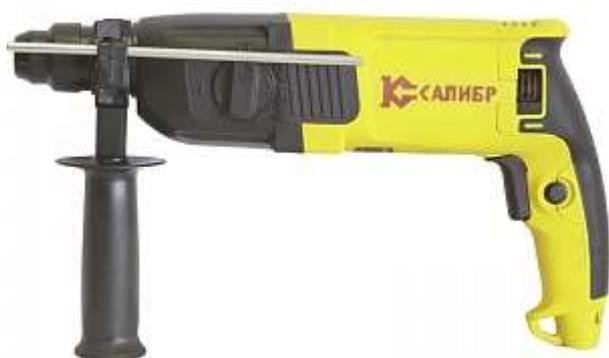
Перфоратор электропневматический ударно - вращательного действия Калибр ЭП-800/26м предназначен для сверления с осевым ударом (бурения), штробления, откалывания и долбления в кирпиче, бетоне, пенобетоне и камне, а так же сверления в древесине, ДСП, металле, пластмассах.
